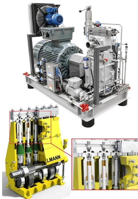
Рис. 9. Загальний вигляд та устрій насоса високого тиску фірми Hammelmann, що використовується для подачі метанолу в систему вприскування двигуна Wartsilä 32
