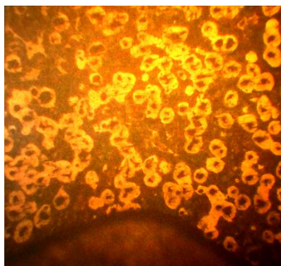
Рис. 3 – Мікроструктура поверхневого шару (Ковш №2), 100x
