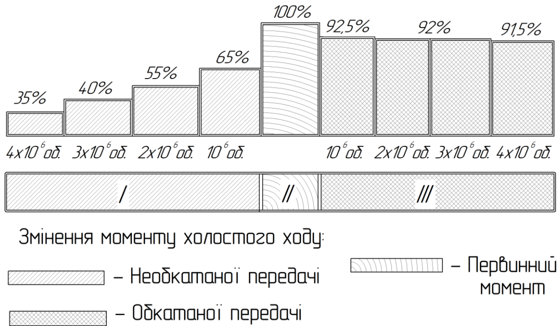
Рисунок 2 – Вплив технологічної обкатки на експлуатаційні показники кульково-гвинтової передачі
