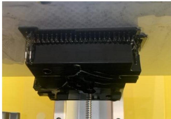
Рисунок 7 – Модель, що надрукована знизу догори на платформі принтеру
