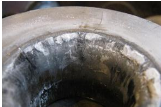
Рисунок 2 – Картина зносу матриці трубопрофільного пресу
