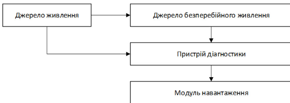
Рисунок 3 – Схема підключення пристрою діагностики
