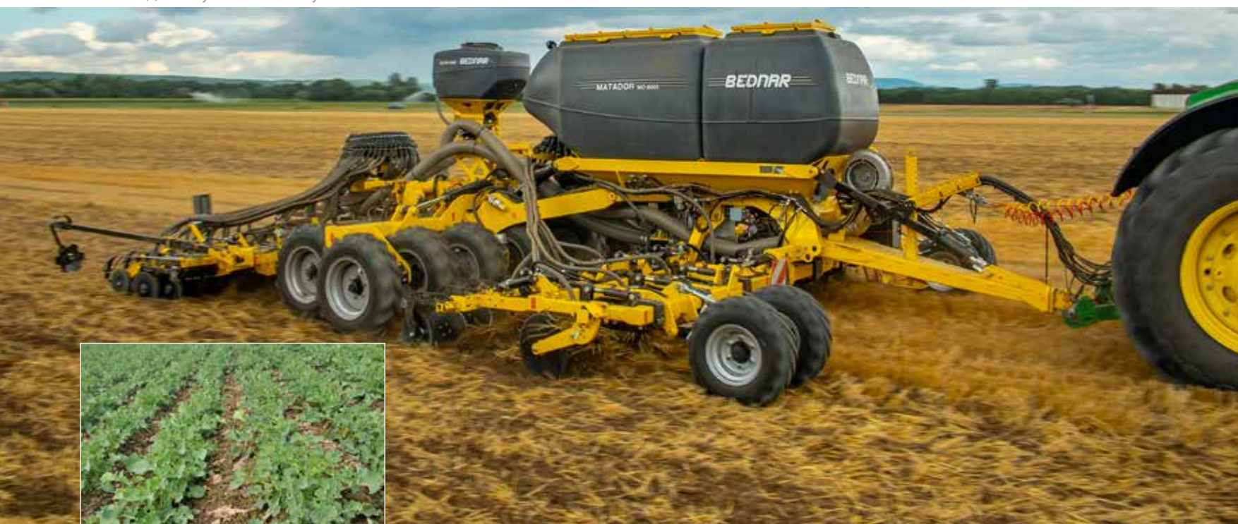
Висів ріпаку сівалкою для смугового посіву MATADOR MO
