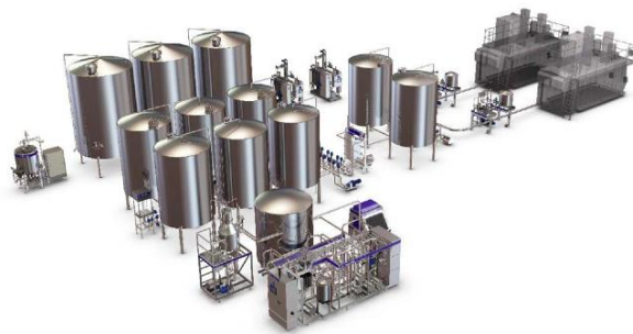
Технологічна схема виробництва Грецького йогурта фірми Тетра-Пак
