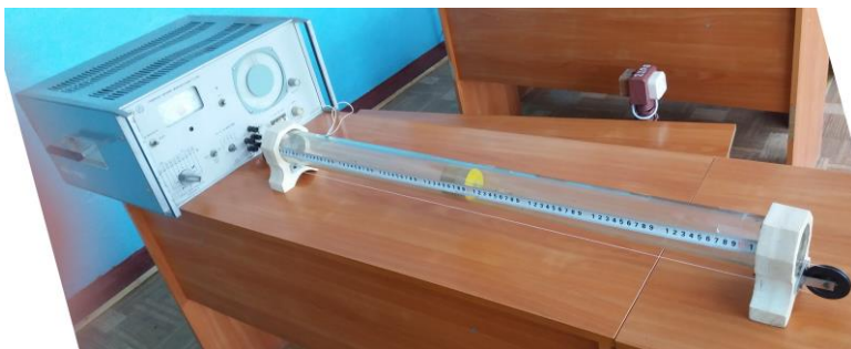
Рис.6 Установка для определения скорости звука в воздухе. Использован генератор сигналов низкочастотный
