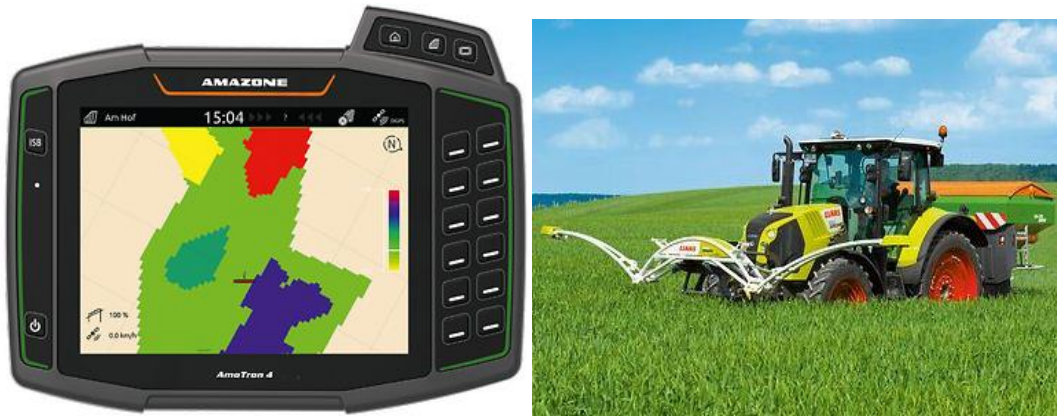
Рис. 1. Диференційоване внесення добрив за аплікаційною картою
