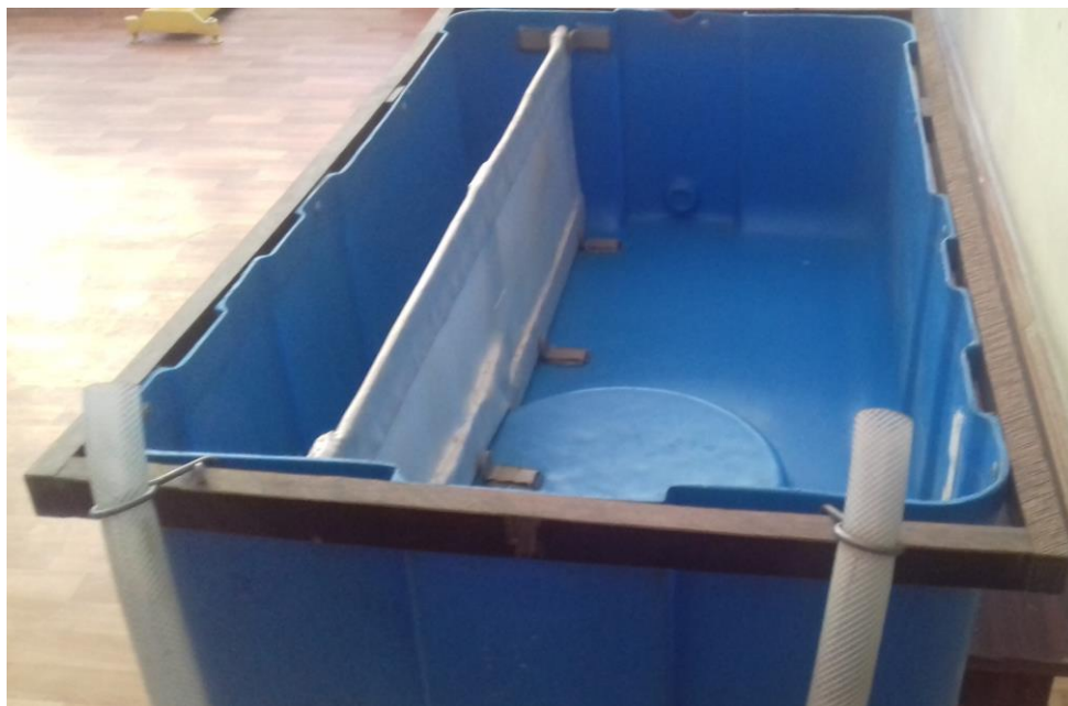
Рис. 3 Внутреннее устройство электролизера
