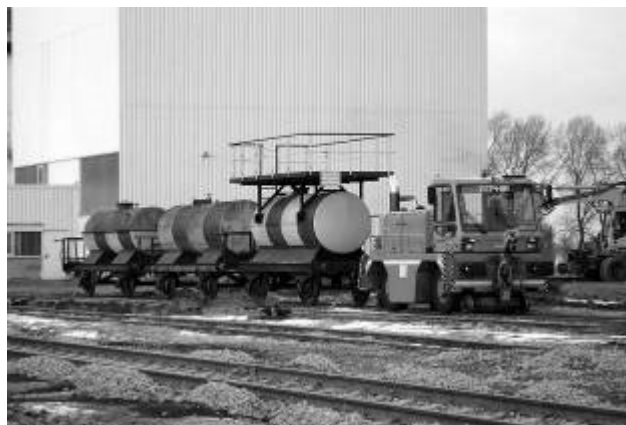
Рисунок 2 – Локотрактор фірми Zephir.
