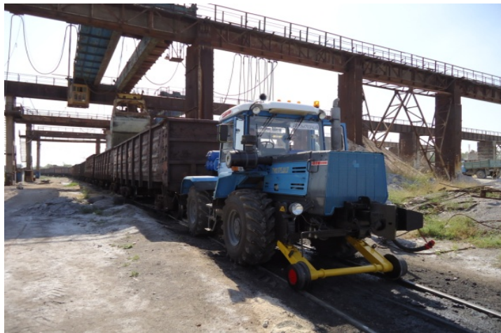
Рисунок 5 – Загальний вид маневрового тягача ТМ 1.175 на базі колісного трактора ХТЗ-150К-09 на коліях промислових підприємств
