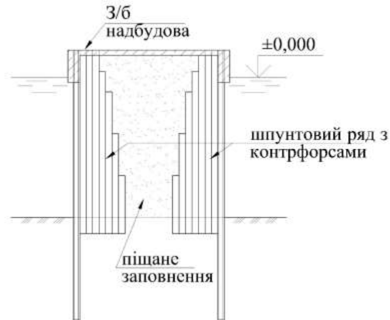
Рисунок 2. Огороджувальна споруда з шпунтових рядів з контрфорсами.
