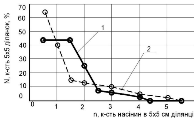
Рис. 6. Рівномірність розподілу насіння по площі поля n -число рослин, шт.; N - кількість 5x5 см 2 ділянок, % 1- дані отримані при сівбі експериментальним сошником; 2- дані отримані при сівбі серійним сошником.
