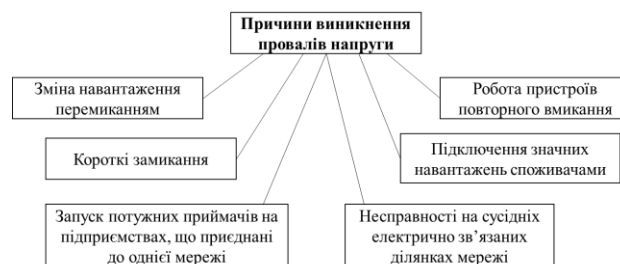
Рис. 1. Причини виникнення провалів напруги в системі
