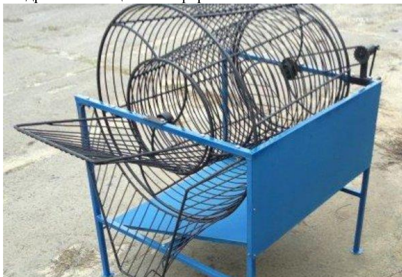
Рис. 11. Барабанна сортувальна машина з паралельним виділенням фракції.
