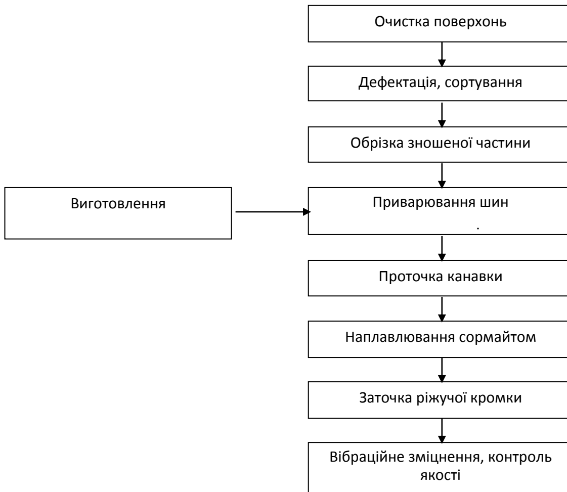
Рисунок 1 - Технологічна схема відновлення і зміцнення лемешів
