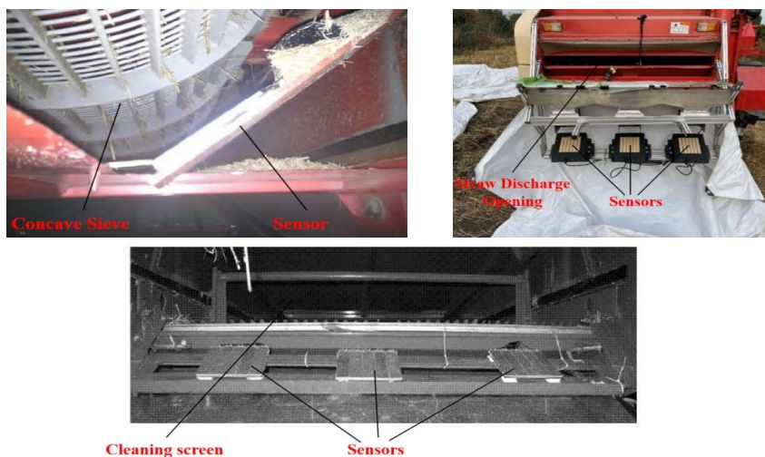
Рис. 2. Різні положення установки датчиків на комбайні.
