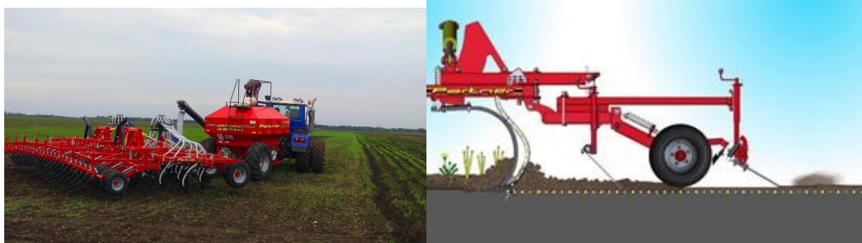
Рис. 1. Сівалка для безрядної сівби, обладнана експериментальними сошниками
