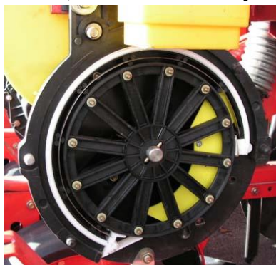
Рис. 11. Висівний апарат зі струшувачем насіння
