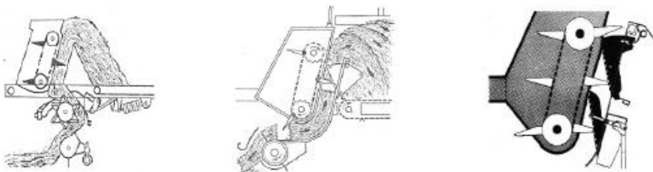
а) з ланцюгово-пальцевим конвеєром подавального пристрою
