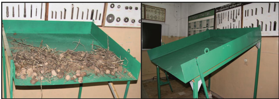
Рис. 3. Ємність для попереднього розміщення і подачі вороху на поверхню органу виносної сепарації
