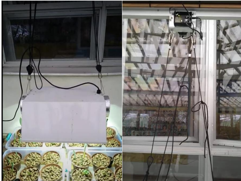
Рис. 4. Конструкція Light Rail, встановлена в ХДАЕУ
