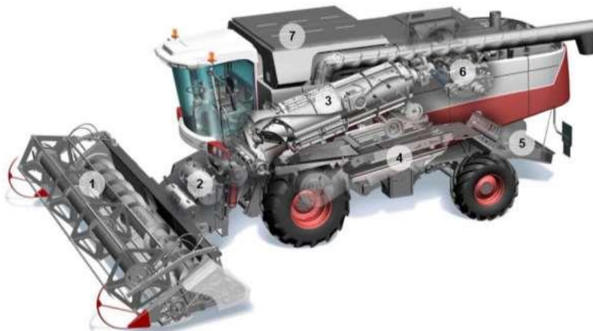
Рис. 2. Загальний вигляд зернозбирального комбайна "Тотум 740" з аксіально-роторним МЗК: 1 – жатка; 2 – похила камера; 3 – роторна молотильна система; 4 – система очищення; 5 – подрібнювач-розкидач; 6 – силова установка; 7 – бункер.
