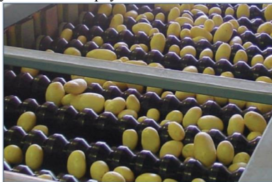
Рис. 7. Калібрування картоплі фасонними роликами
