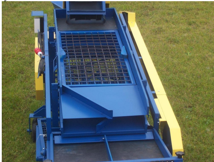
Рис. 13. Машина для сортування картоплі з рухомим решетом
