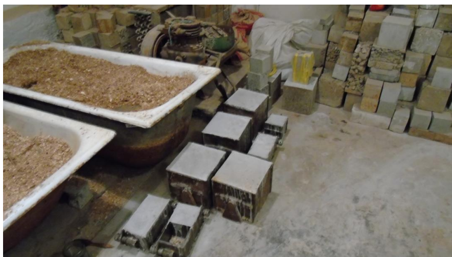
Рис. 2. Виготовлення зразків композитних блоків для збірно-розбірних фортифікаційних споруд
