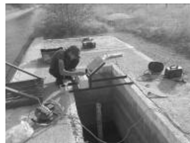
Рисунок 4 - Проверка опытного образца датчика уровня воды ДУВ-2/0,005-10 в производственных условиях [3]
