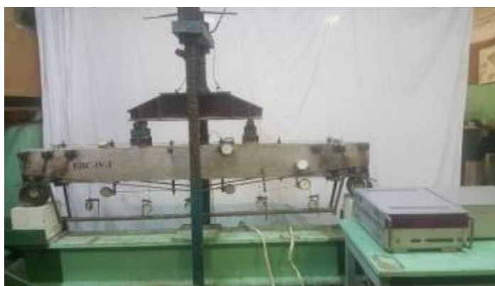
Рис. 2. - Схема випробування підсиленої балки серії БПС-IV-2, загальний вигляд випробування.
