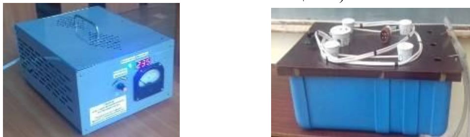
Рис. 1 Прибор для управления процессом электрохимической активации воды. Слева - блок управления, справа – ванна электролизера.
