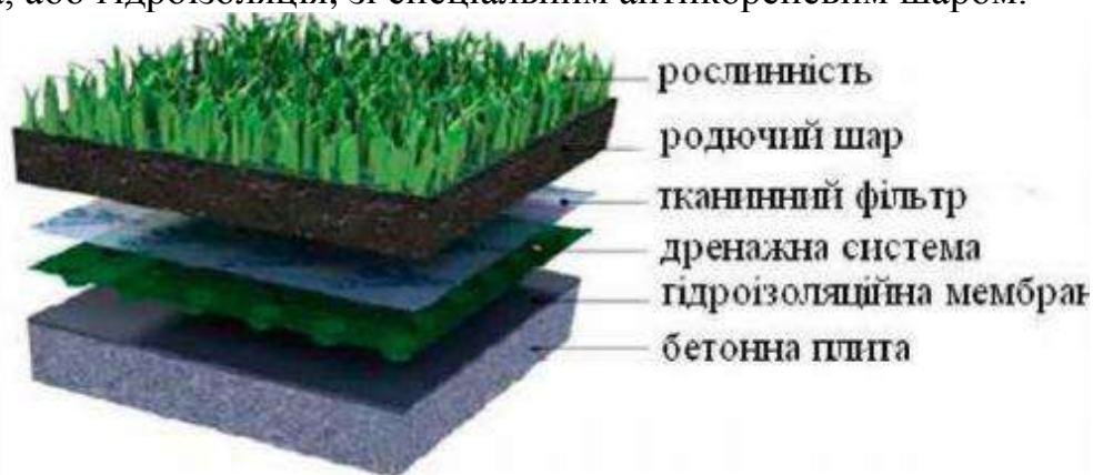
Рис.2 Типова конструкція зеленого даху
