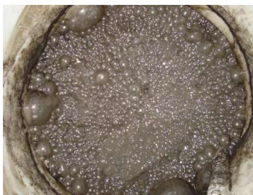
Рис. 3- Процесс флотации измельченной отвальной породы в опытах
