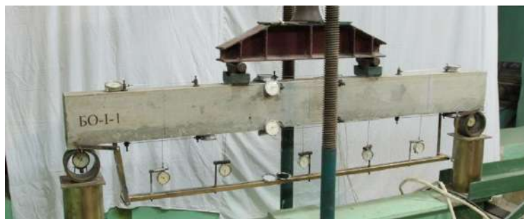
Рис. 1 - Фото випробування підсиленої балки серії БО-I-I
