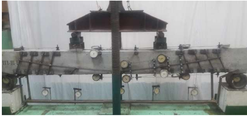
Рис. 2 - Фото випробування підсиленої балки серії БПП-III-I
