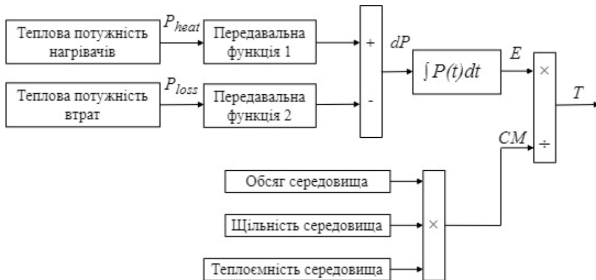
Рисунок 1 – Схема обчислення динамічного процесу нагрівання та охолодження фізичного середовища будівлі
