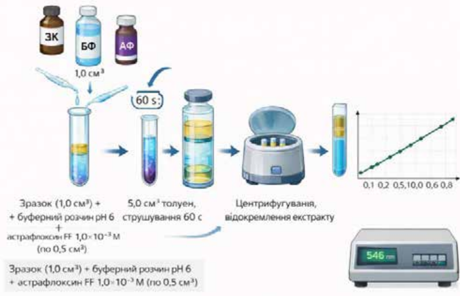
Рис. 2. Схема екстракційно-фотометричного визначення саліцилової кислоти з використанням катіонного ціанінового барвника астрафлосину АФ
