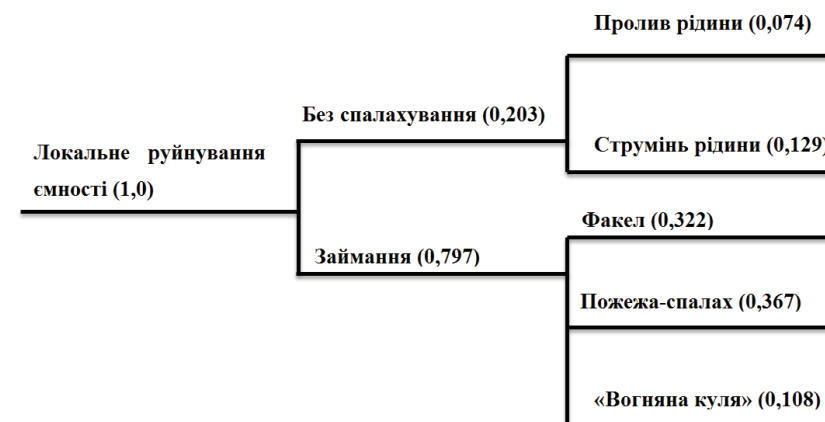
Рис. 1. Аналіз розвитку НС на АЗС внаслідок руйнування ємності за допомогою «дерева подій» [2]
