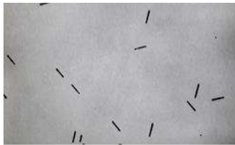
Рис. 7. Поверхня варикапної структури з виявленими ОДУ
