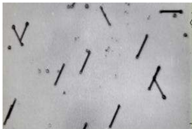
Рис. 2. Поверхня діодної структури з виявленими ОДУ
