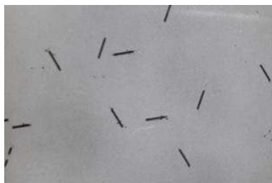
Рис. 18. Мікрофотографія поверхні епітаксильної структури після термічного окислення і проведення селективного травлення
