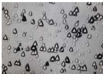
Рис. 22. Мікрофотографія поверхні епітаксіальної плівки перед операцією термічного окислення після селективного травлення
