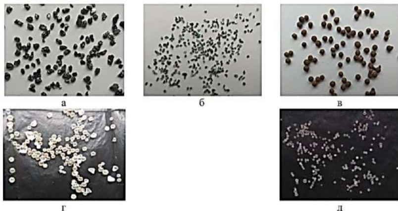
Рис. 7. Морфологічний аналіз досліджуваних абразивних матеріалів: а – ККЧ, б – ККЗ, в – ДЧЛП (ЧС5), г – КУ-2-8 (фракція 1,5 мм), д – КУ-2-8 (фракція 0,5мм)
