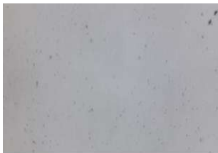
Рис. 19. Поверхня варикапної структури, виготовленої з використанням гетерування, після розгонки бору
