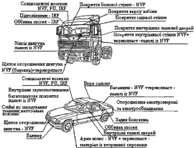
Рис. 5. Застосування натуральних рослинних волокон у різноманітних конструкційних елементах автомобіля
