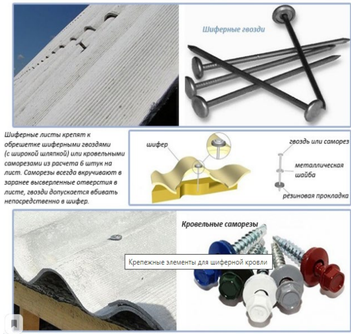
Рис. 6. Крепёжные элементы для кровли из шифера
