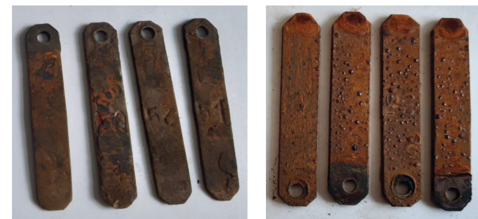
Рис. 3. Загальний вигляд зразків після витримки в напірному трубопроводі НС-1
