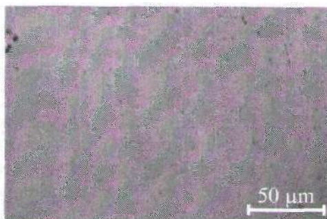
Рис. 4. Поверхня діодної структури, виготовленої із застосуванням передокислювального високотемпературного відпалу, після селективного травлення
