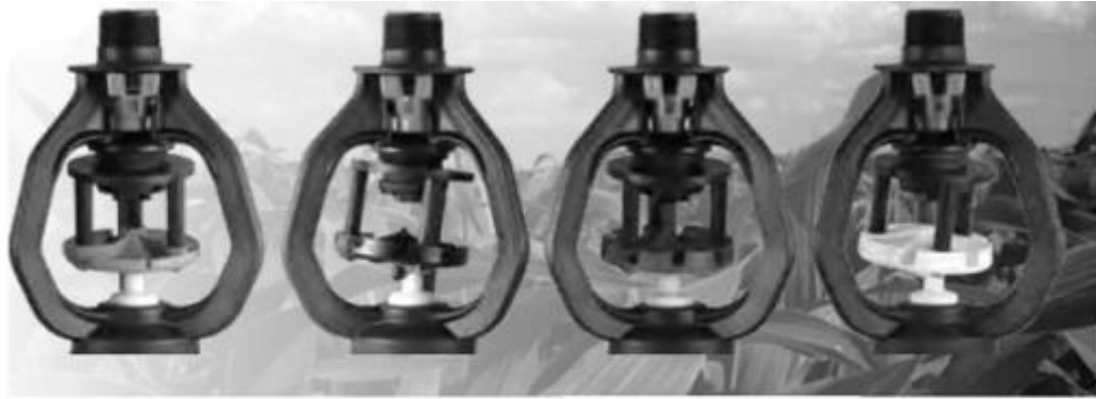
Стандартний кут 6 канавок Сірий розсікач Малий розмір капель Стандартний кут 9 канавок Чорний розсікач Середній розмір капель Малий кут 9 канавок Синій розсікач Середній розмір капель Малий кут 6 канавок Білий розсікач Максимальний розмір капель
