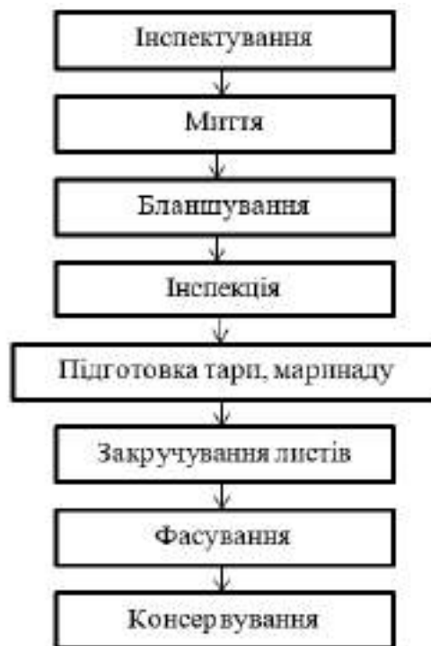
Рисунок 3. Блок-схема виробництва консервованого виноградного листа
