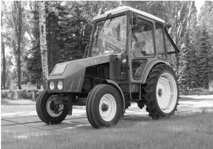
Рис. 2 – Дослідний зразок електротрактора на базі трактора ХТЗ – 2511Е
