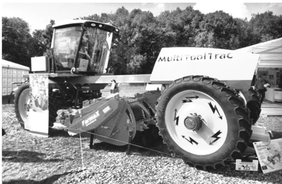
Рис. 1 – Голландський повнофункціональний сільськогосподарський трактор на електричному ході Multi Tool Trac
