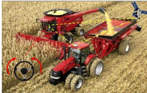
Рисунок 1 – Синхронізація роботи машин за допомогою системи V2V
