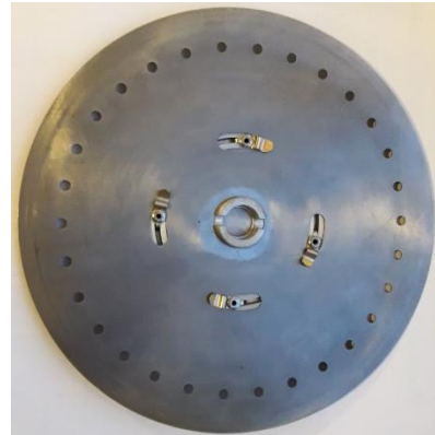
Рис. 3.2 – Висівний диск для дослідної сівалки
