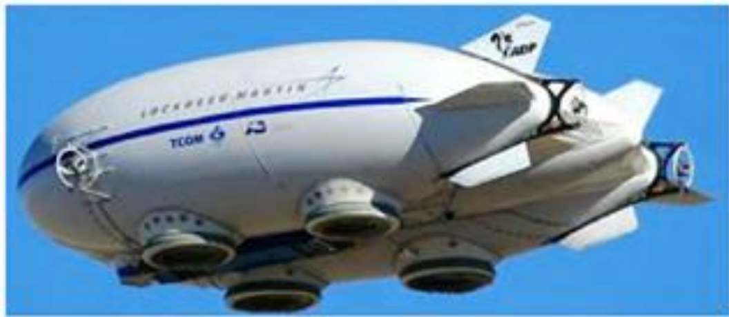
Рисунок 2. – Гібридне повітряне судно, Р- 791, США.
