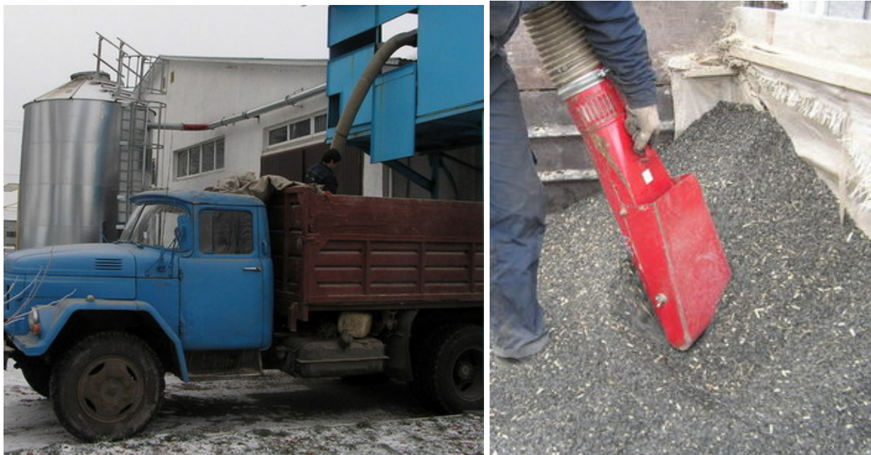
Рис. 1. Застосування мобільного пневмоперевантажувача зерна на малопотужному виробництві
