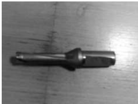
Рис. 2. Свердло зі швидкозмінними пластинами
