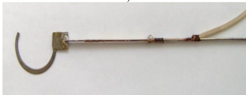
Рис. 1. Датчик, для визначення коефіцієнту динамічної в'язкості: а) з круглою пластиною; б) з напівкруглою пластиною
