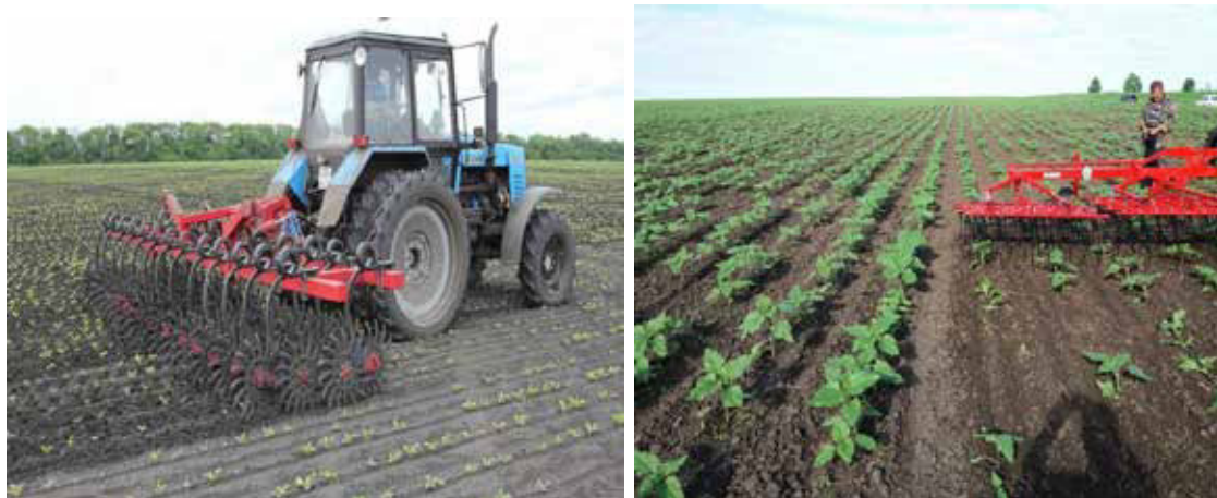
Рис. 1. Знищення бур'янів у досліді (біологізована II та органічна технології вирощування) ротаційною мотикою (ліворуч) та штригельною бороною (праворуч)
