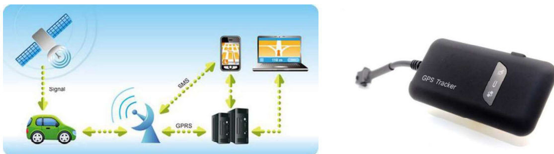
Рис. 3 – GPS-трекер: схема дії та зовнішній вигляд
