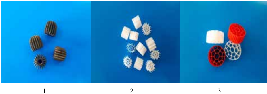
Рис. 1. Біозавантаження реактора біофільтра із поліпропілену: 1 – AQ-15 (Данія); 2 – Kar-sib (Україна), 3 – Aquamag (Україна)
