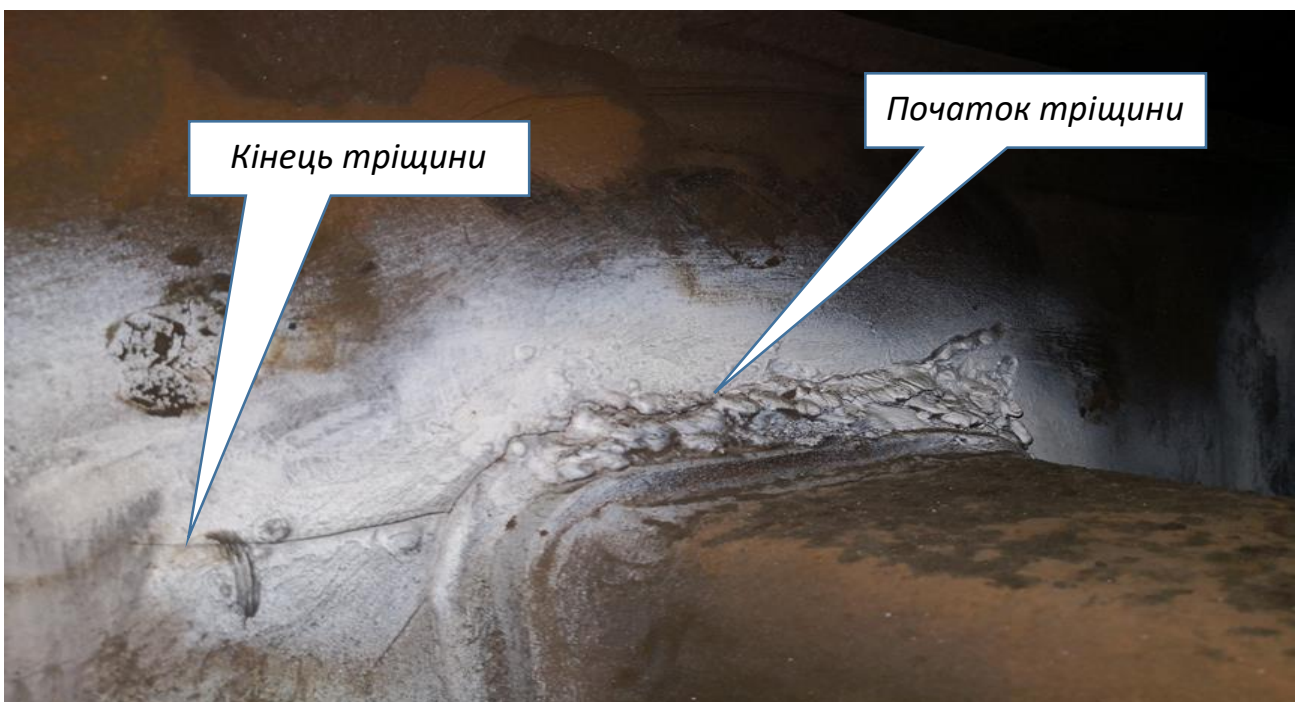
Рис.1. Виявлена тріщина над одним з гальмівних кронштейнів.
