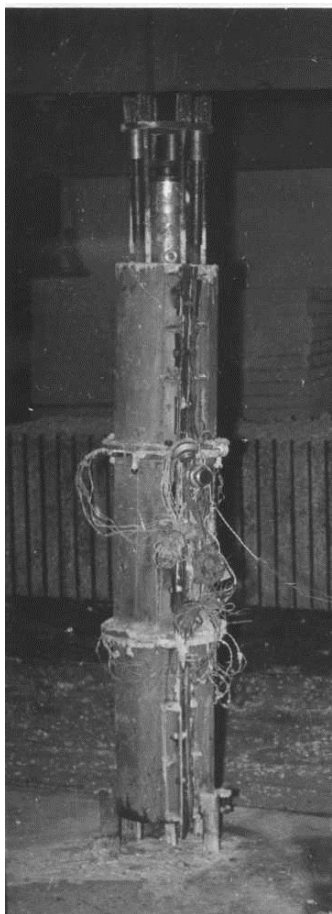
Рисунок 1 - Загальний вигляд колони, зміцненої попереднім обтиском бетону ядра
