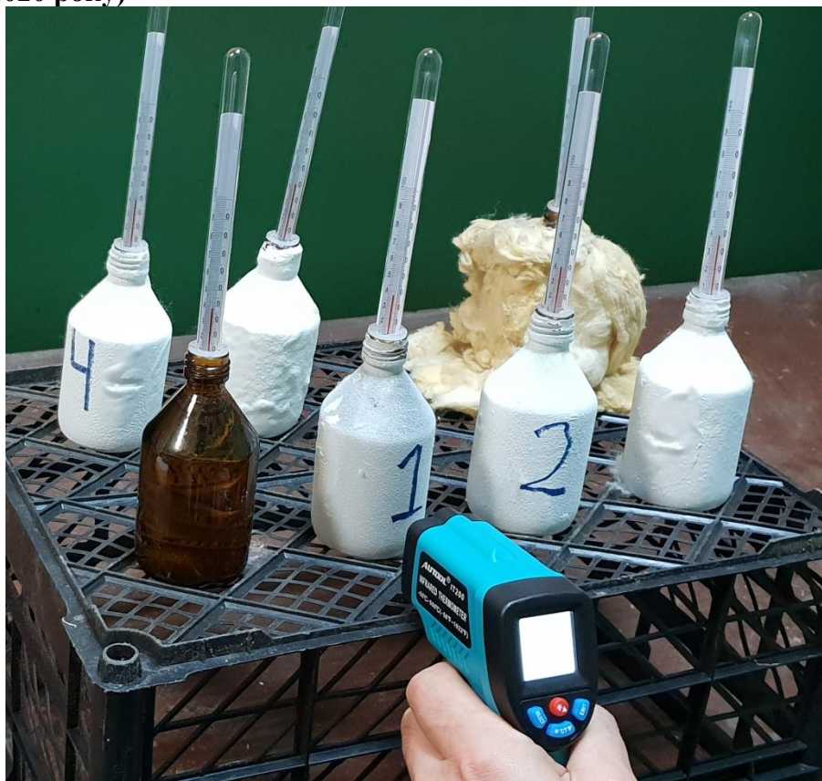
Рис.1. Оцінка теплоізоляційних властивостей фарбового покриття
