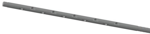
Рис. 4. Окно программы КОМПАС 3D – Трехмерная модель вала катка
