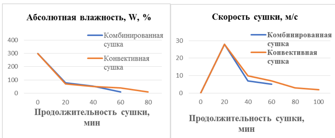
Рис. 3. Кривые изменения влажности и скорости сушки свеклы в зависимости от способа сушки
