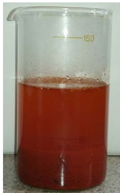
Зразок 2. Якісна сировина. Порошок відразу випав в осад, розчин має характерний оранжево-червоний колір.
