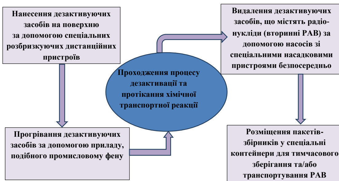
Рисунок 3. Технологічний процес дезактивації поверхнево забруднених матеріалів
