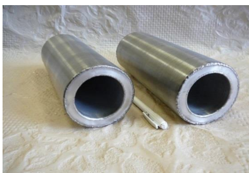
Рис. 9. Конструкція і загальний вигляд теплотрубних термостатів-термосів, призначених для підтримки значень нульових температур
