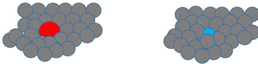
Рис. 1. Два фрагменти псевдогексагональної упаковки іонів в кристалічній ґратці заліза та дислокації, утворені присутністю більшого за розмірами іону калію (праворуч) й меншим за розмірами іоном арсену (ліворуч).
