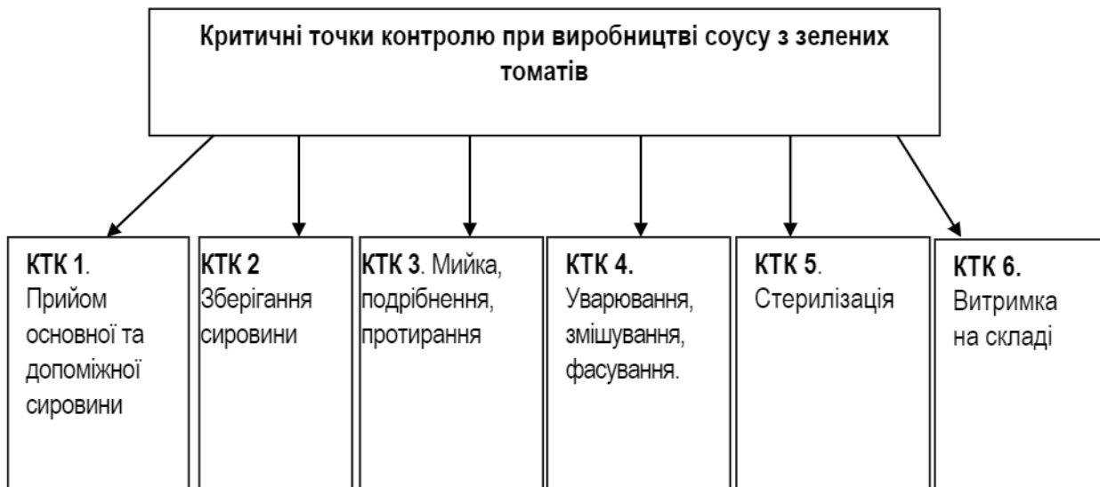
Рис. 1. Критичні точки контролю при виробництві соусу з зелених томатів
