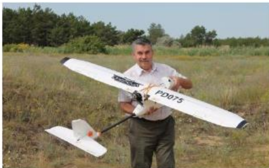
Рис. 1. БПЛА за літаковою аеродинамічної схеми на платформі PD075, підготовка до запуску
