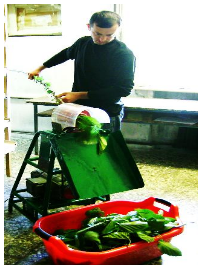
Рис.5. Модернизированная механическая листорезка “РТЛ– 25”.
