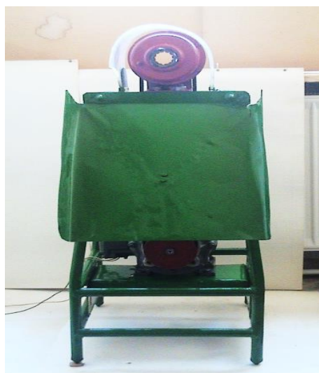
Рис. 4. Устройство для отделения листьев от веток “ПС-1”.
