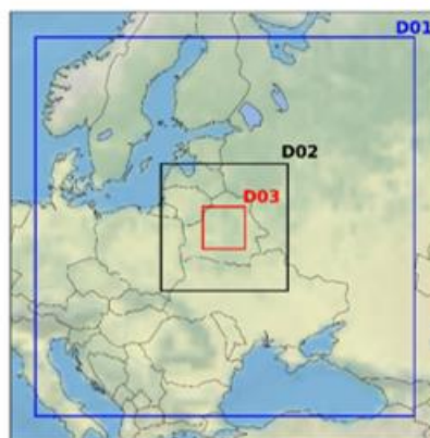
Рис 2. Карта охвата территории областей (доменов) 9 км (D01), 3 км (D02), 1 км (D03) вычислительного эксперимента
