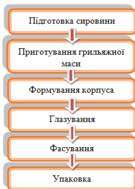
Рис. 1. Блок-схема виробництва грильязу «Південного» безперервним способом
