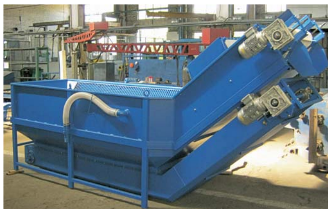
Рис. 10 – Загальний вигляд машини мийної V-VM422
