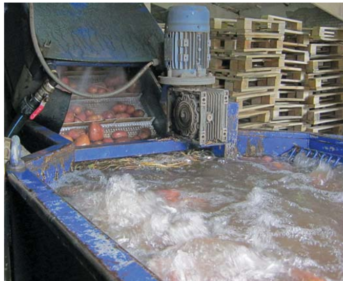
Рис. 12 – Машина мийна V-VM422 у роботі
