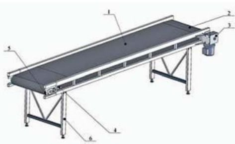
Рис. 5 – Конструкційна схема транспортера стрічкового інспекційного V-СВ4/06 1 – транспортерне полотно; 2 – ведучий барабан; 3 – мотор-редуктор; 4 – вузол натяжки; 5 – ведений барабан; 6 – регульовані опори
