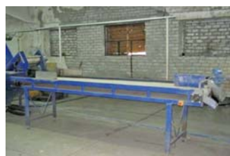
Рис. 4 – Загальний вигляд транспортера стрічкового інспекційного V-SB4/06
