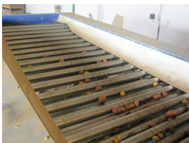
Рис. 9 – Просування картоплі вздовж роликового транспортера (процес калібрування)
