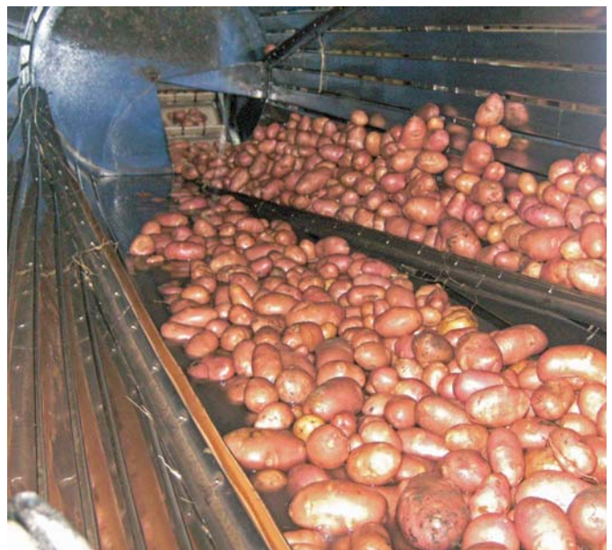
Рис. 15 – Просування картоплі вздовж обертового барабана
