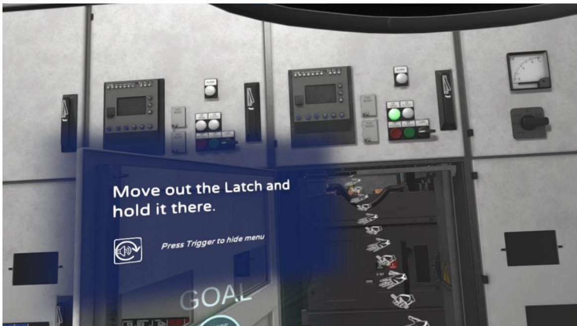
Рис.5. Наступна підказка - висуньте засувку та утримуйте її там.
