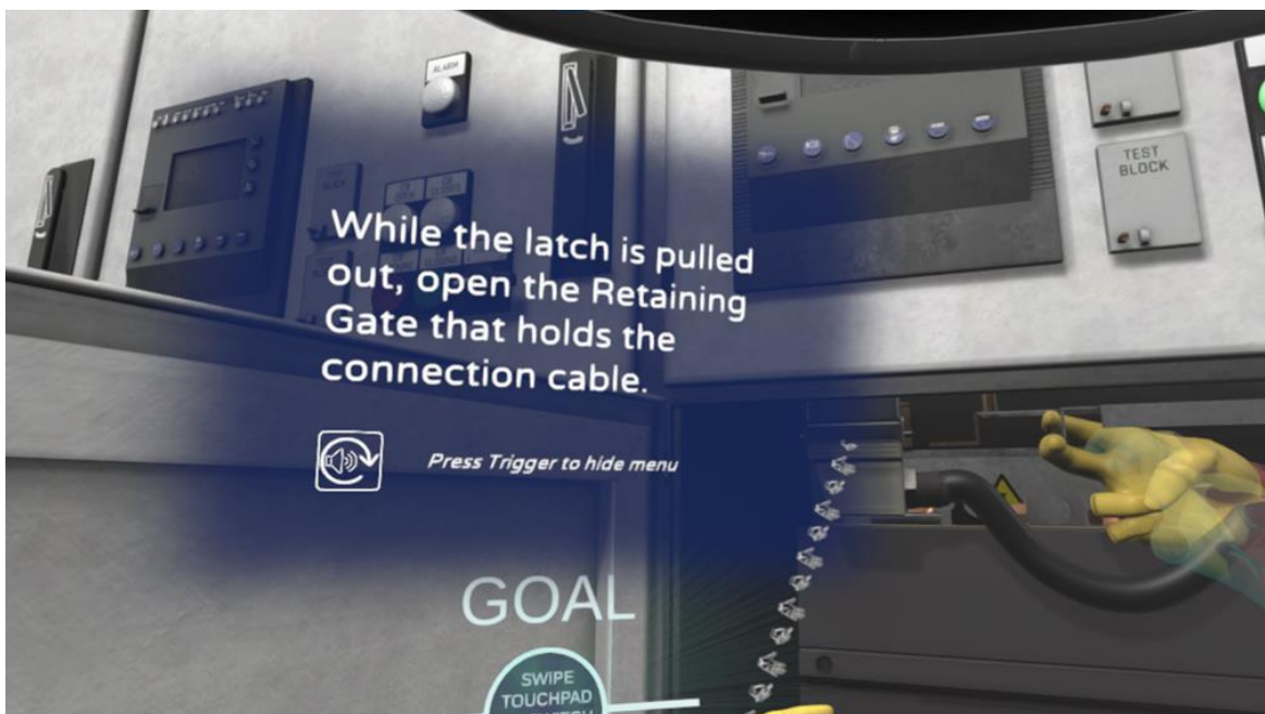
Рис. 6. Підказка - поки фіксатор витягнутий, відкрийте заслінку, яка утримує з'єднувальний кабель.
