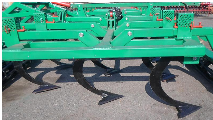
Рис. 2. Загальний вигляд стрілочастих плоскоріжучих лап на серповидних стовбах культиватора КВАНТ-7
