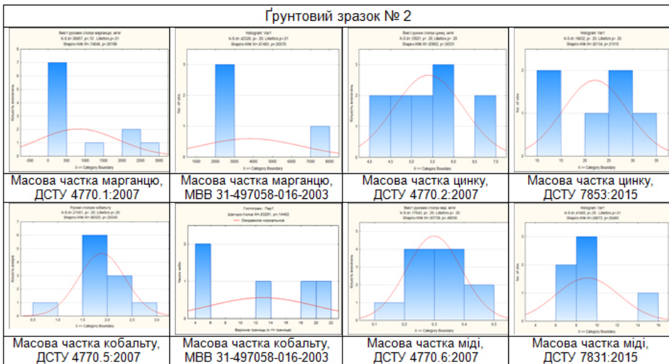
Рис. 2. Результати апроксимації міжлабораторного експерименту нормальним розподілом з довірчою ймовірністю 95% в другому ґрунтовому зразку
