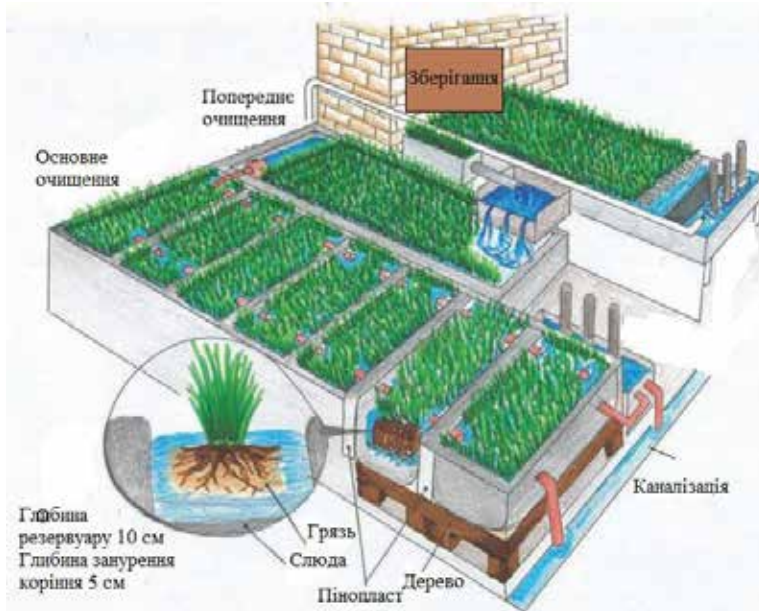
Рис. 2. Технологічна схема зеленого даху для очищення стічних вод
